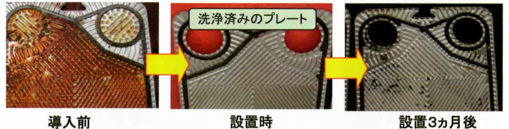
温泉で使用している熱交換器での事例です。導入前は、**2週間ほどでスケールが固着し、詰まってしまう**為、塩素系の薬剤を投入していました。一度洗浄し、綺麗な状態にしてからモールドウォーターを設置しました。3ヵ月後に全く、スケールが付着せず良い状態を維持しておりました。**17ヵ月後に確認した際にも、全く清掃せず使用できている**とのことです。
